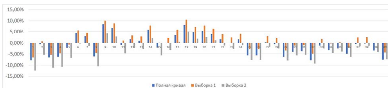
Рис. 5. Отклонение прогнозных значений скорости продольных волн, полученных по значениям удельного сопротивления, от измеренных значений скорости
