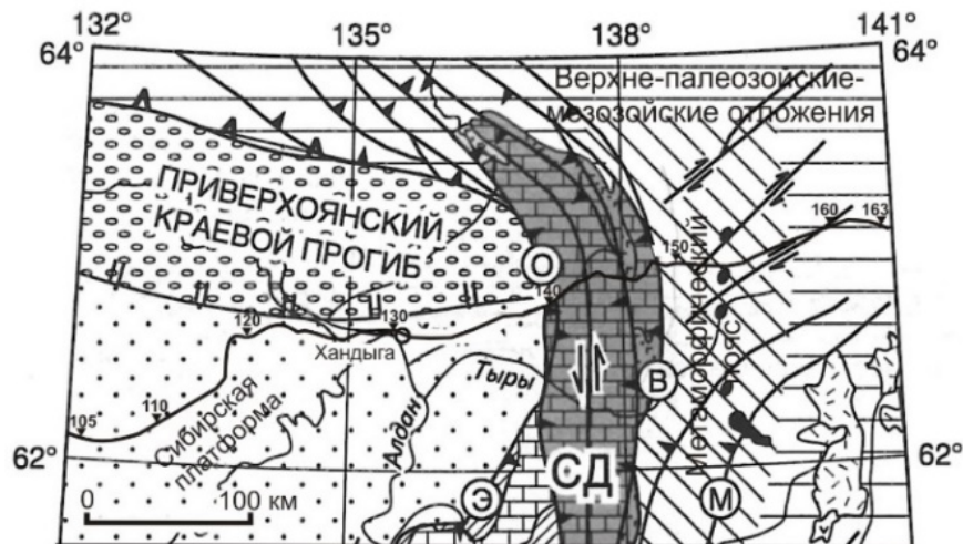
Рис. 1. Положение рассматриваемого участка профиля 3-ДВ на структурной схеме [3]. Криволинейная трасса наблюдений (вдоль зимней автотрассы) показана жирной линией с номерами пунктов возбуждения МПВ.
