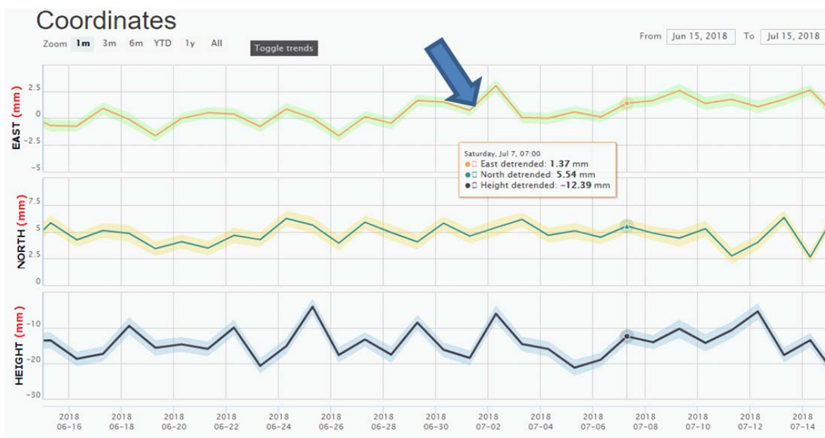
Рис. 3. 3-D смещение пункта NVSK (на В, на С и вверх) в миллиметрах в период с 00 ч. - 00 м. 15 июня по 00 ч. - 00 м. 15 июля 2018 года.
