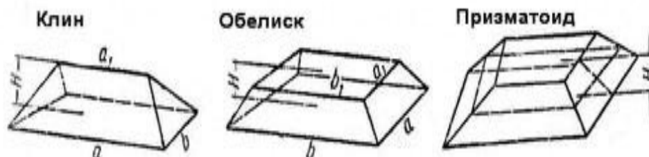
Рис. 1. Примеры хранения руды, занимаемой правильными геометрическими объемами
