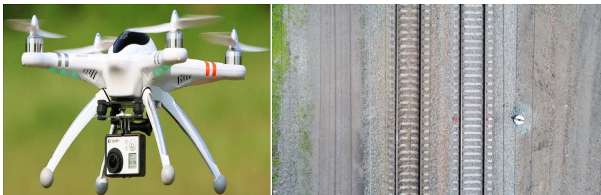
Рис. 4. Съемка пути с применением БПЛА
