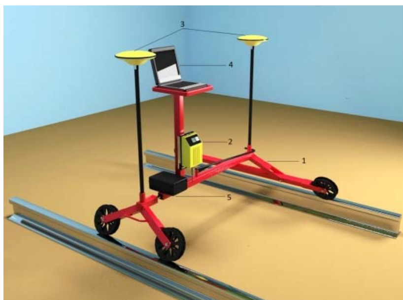
Рис. 4. Аппаратно-программный комплекс (АПК) «Профиль-М»
