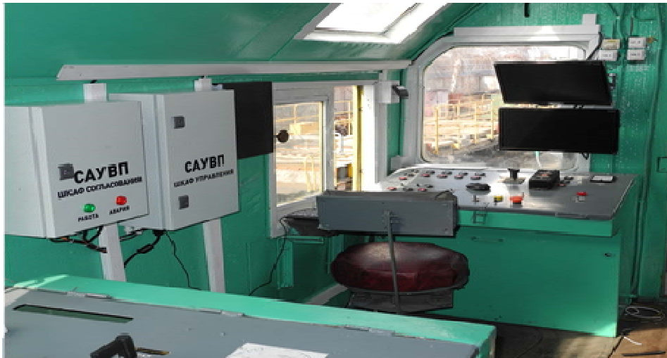
Рис. 10. ВПО 3-3000, оборудованный САУ-3Д (блок согласования и управления САУ ВПО)
