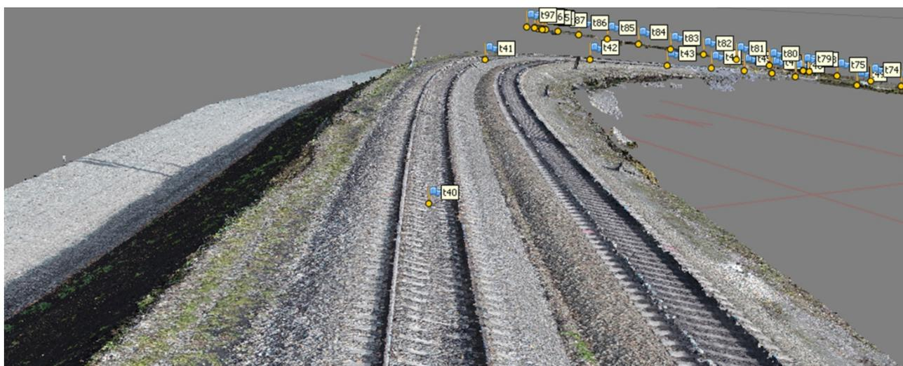
Рис. 2. Точечная модель с отображением положения опорной точки № 40
