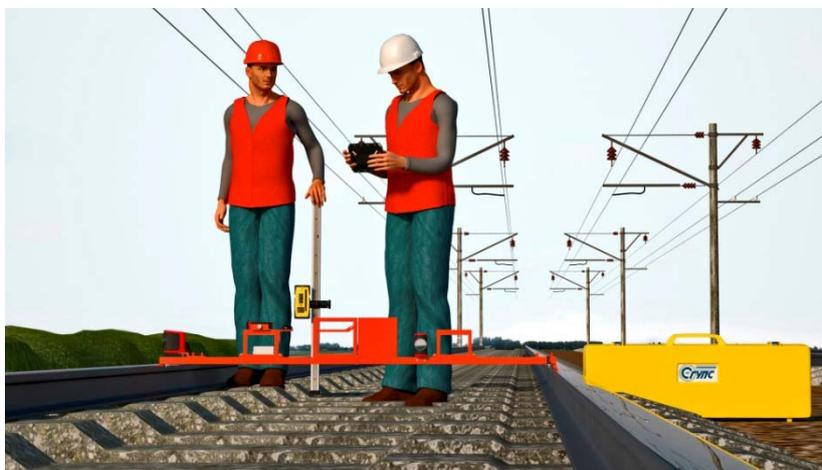
Рис. 5. ПДМ в процессе оценки состояния рельсовой колеи
