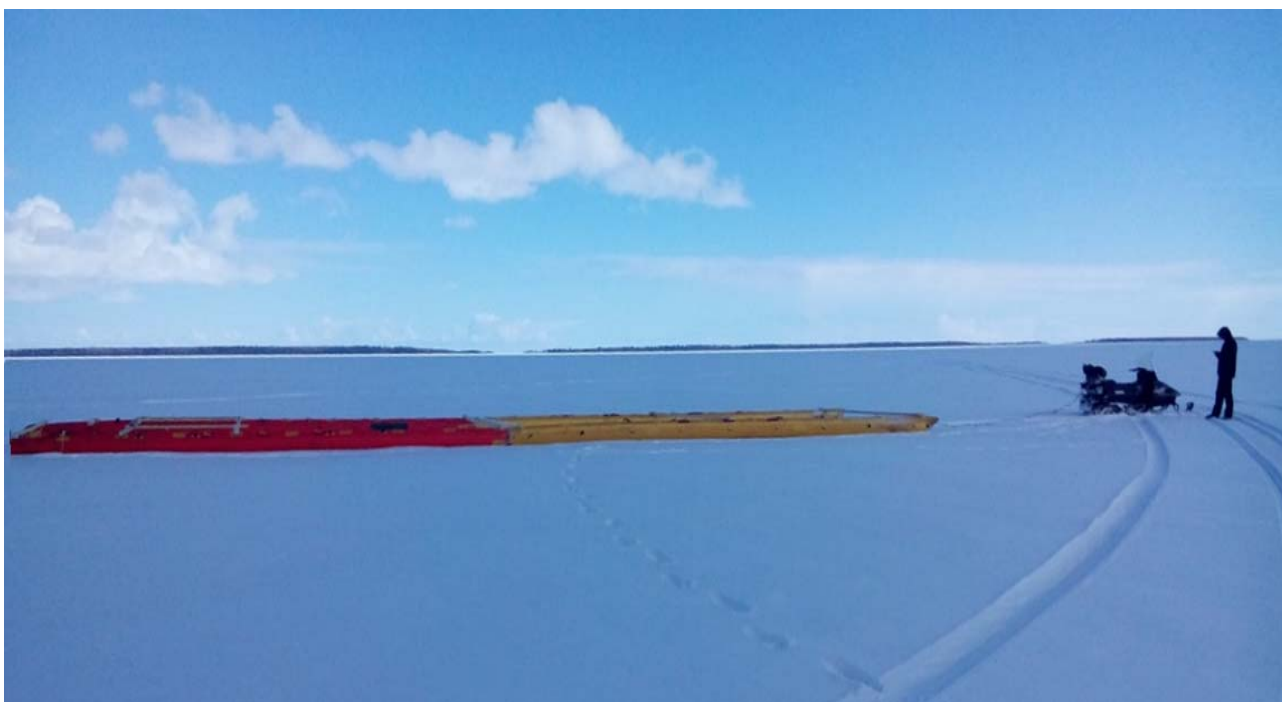
Рис. 1. Пример измерительного комплекса ЭМС (буксируемая приемно-генераторная конструкция)
