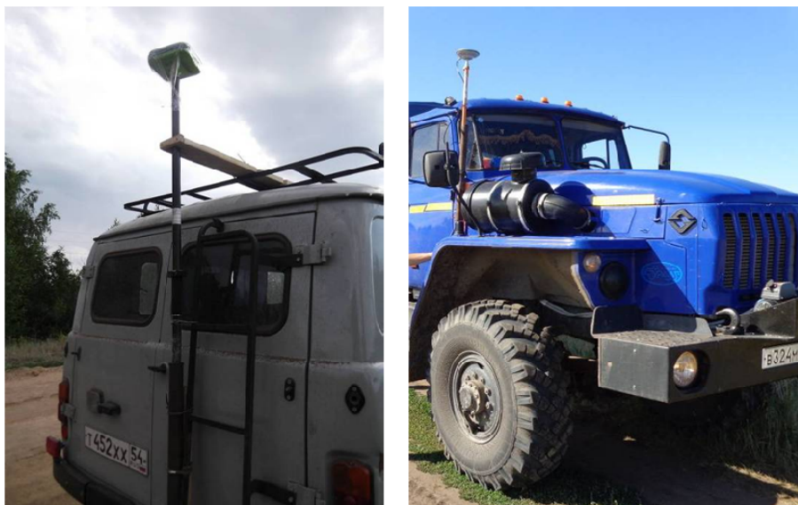
Рис. 1. Закрепление антенны ГНСС-приемника на автомобиле при проведении гравиметрической съемки
