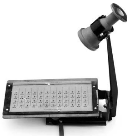
Рис. 1. 48 элементная ОАР с первичным облучателем
