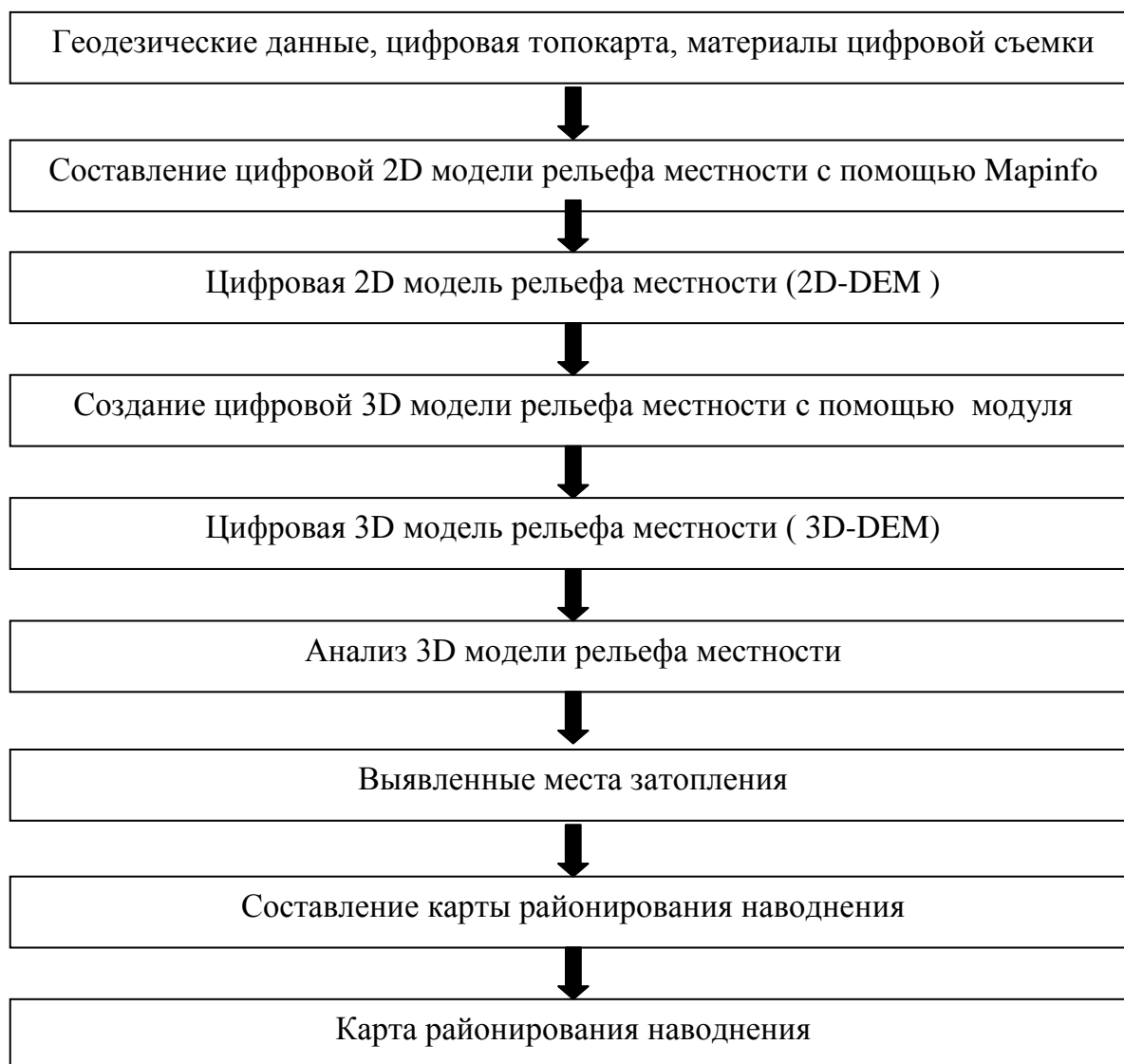
Рис. 1. Схема процесса составления карт районирования наводнения
