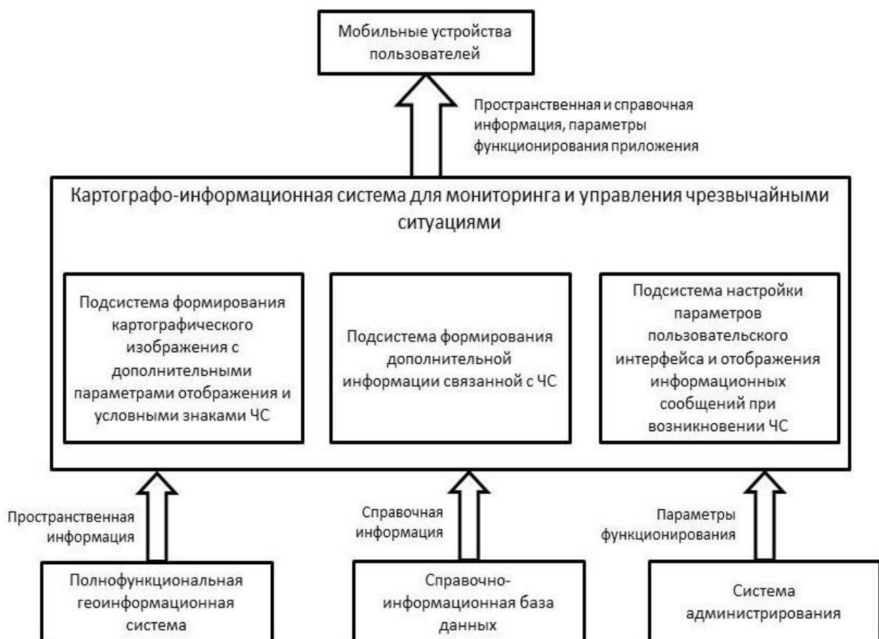
Рис. 1. Картографо-информационная система для мониторинга и управления чрезвычайными ситуациями
