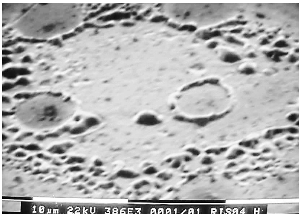
Рис. 2. СЭМ снимок области алюминиевой плёнки, подвергнутой лазерному облучению
