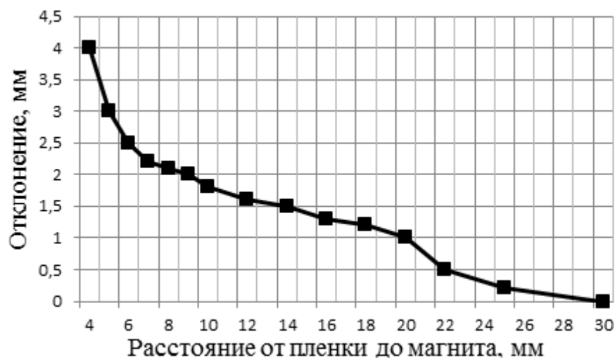
Рис. 5. График зависимости амплитуды отклонения пленки при приближении магнита
