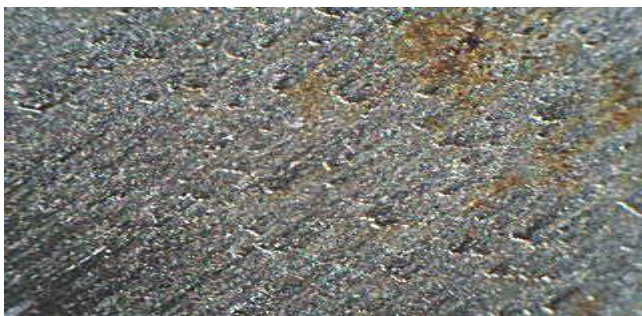
Образец шероховатости - Фрезерование цилиндрическое Ra = 5
