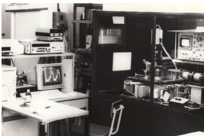
Рис. 4. Установка АС-700 для контроля топологии фотошаблонов датчиков угла поворота
