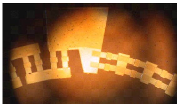
Рис. 3. Фрагмент топологии ЧЭ, изготовленного по технологии растрового сканирования
