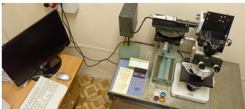
Рис. 1. Фотография разработанного цитофотометрического устройства
