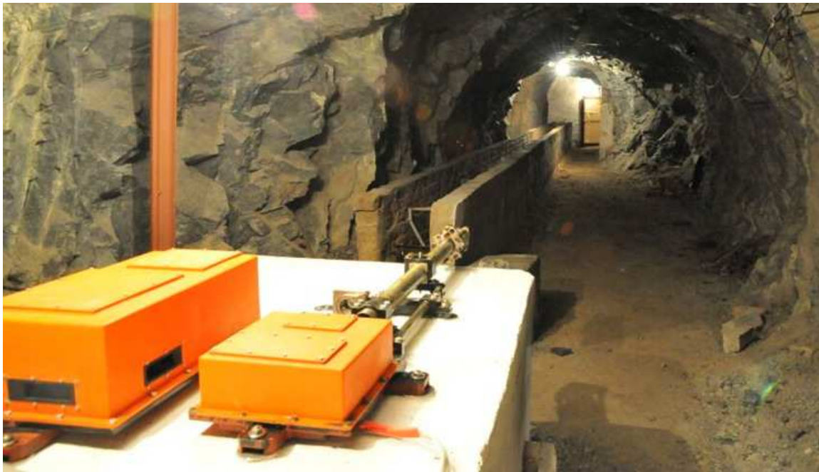
Рис. 8. Двухканальный лазерный деформограф в штольне «Талгар» Алматинского прогностического полигона
