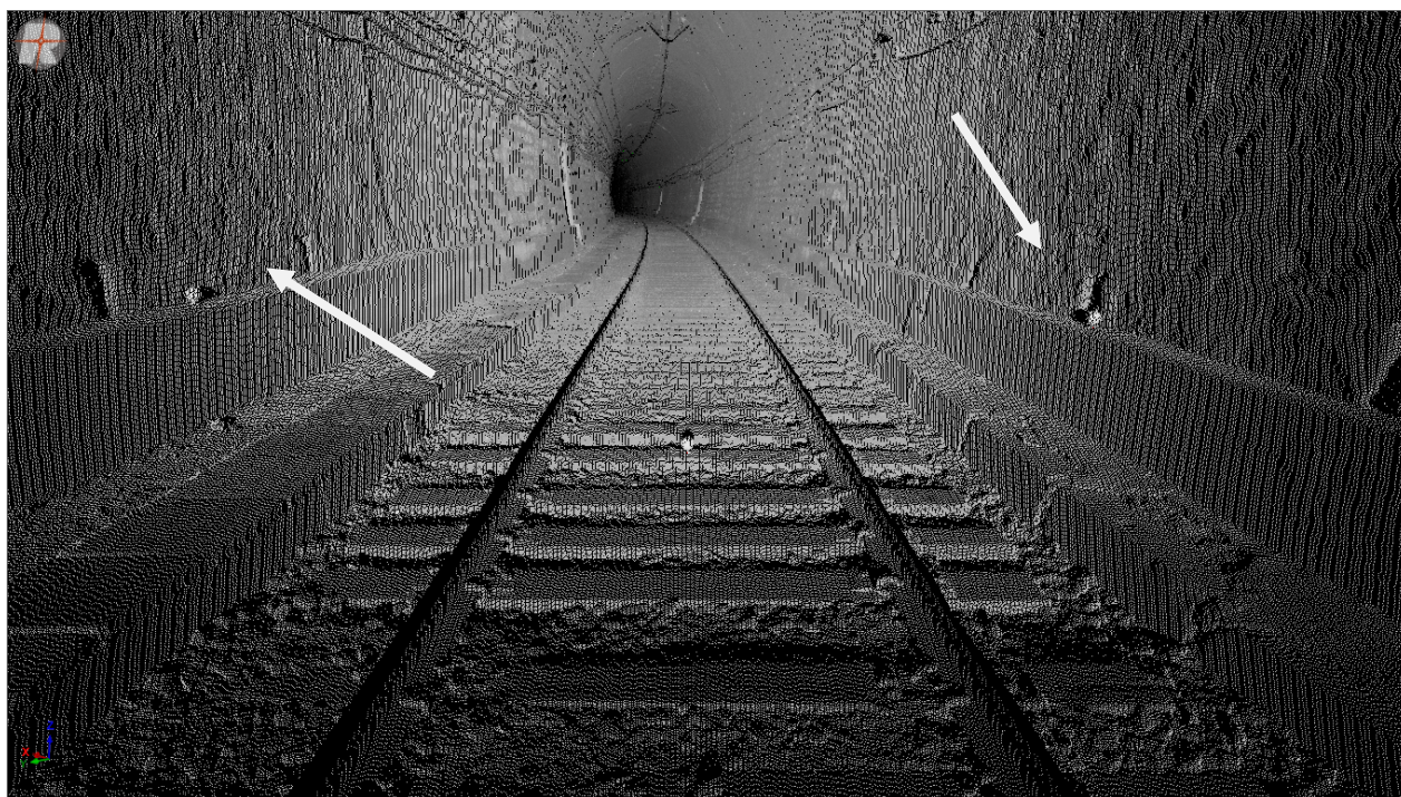
Рис. 3. Место установки сферических марок
