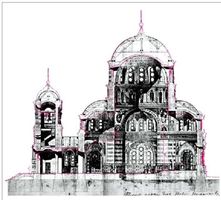
Рис. 8. Сопоставление проектного чертежа с обмерами
