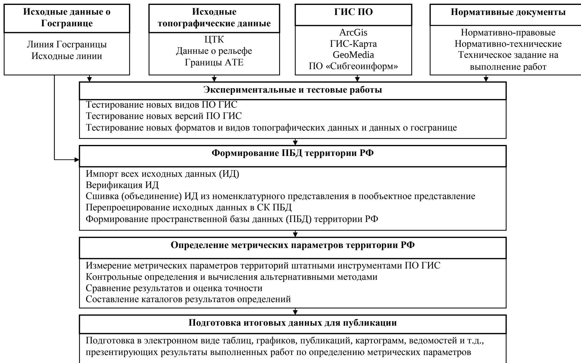
Рис. 1. Принципиальная технологическая схема определения метрических параметров территории Российской Федерации с использованием ГИС-технологий
