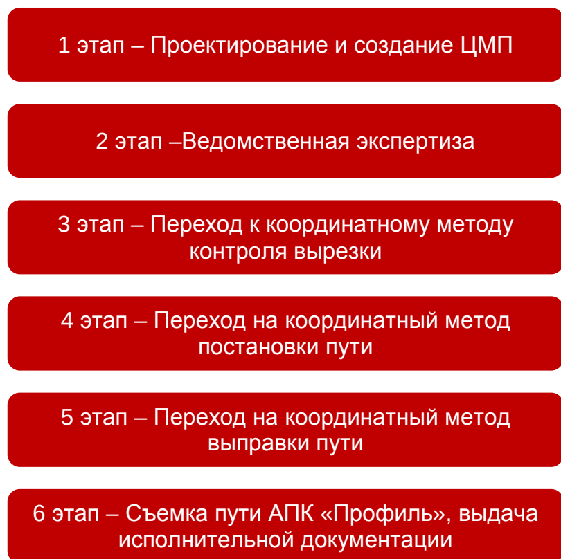
Рис. 1. Этапы внедрения в технологию реконструкции (модернизации) и капитального ремонта пути
