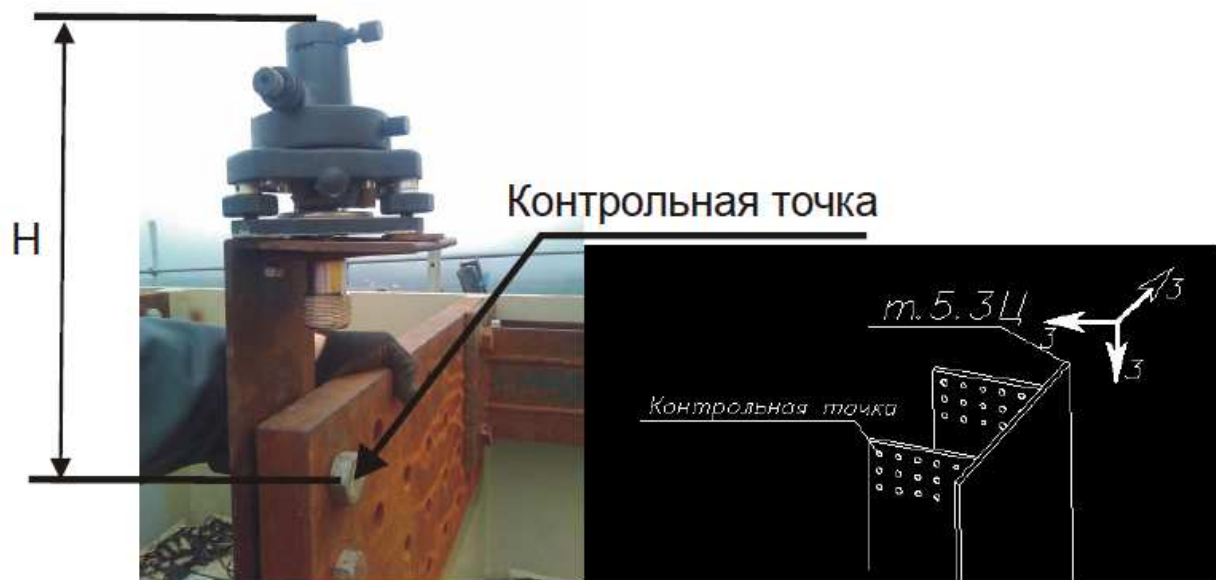
Рис. 2. Контрольные точки для определения «узла» крепления вант
