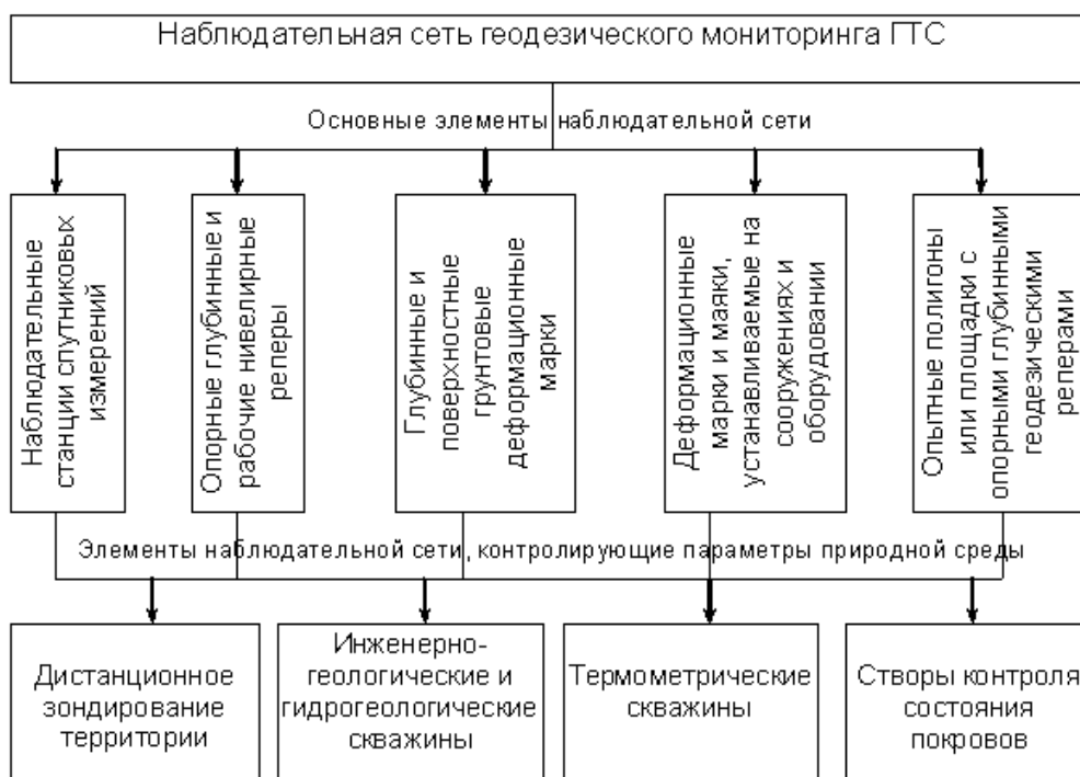
Рис. 1. Состав наблюдательной сети геодезического мониторинга ГТС
