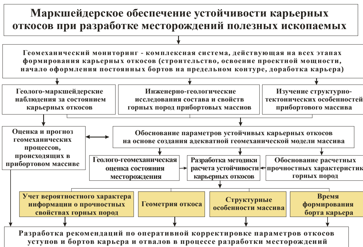
Рис. 1. Маркшейдерское обеспечение устойчивости карьерных откосов
