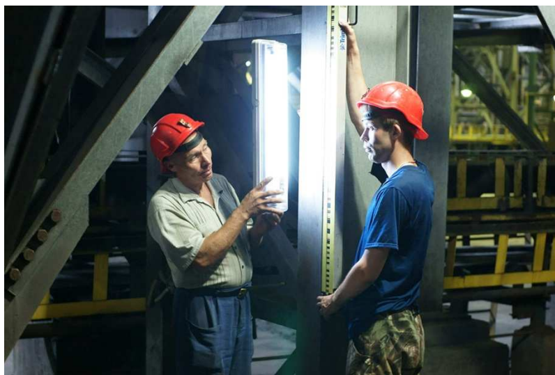
Рис. 2. Использование цифрового нивелира в темных помещениях
