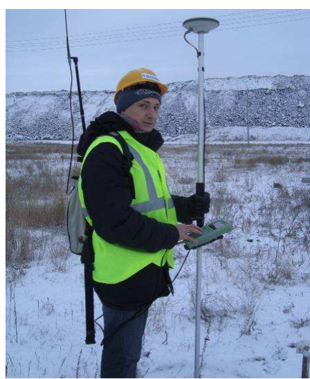
Рис. 3. Исследование сдвижения приборного массива на карьере «Варваринское» с помощью GPS
