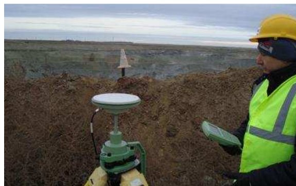
б – наблюдения с помощью ГНСС (карьер Варваринский-Центральный)
