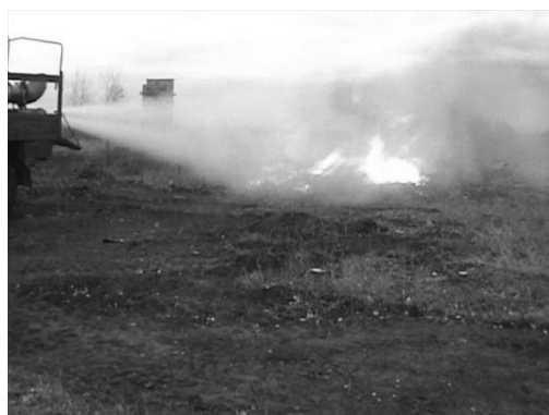
Рис. 2. Тушение очага низового лесного пожара потоком аэрозоля 30 % раствора K_3[Fe(CN)_6]
