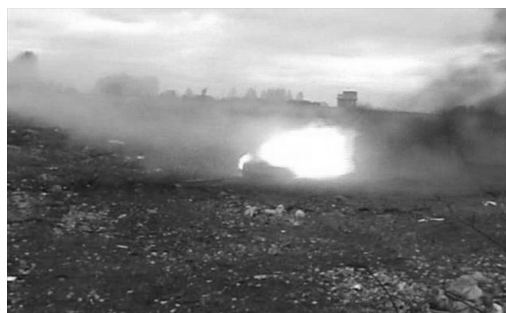
Рис. 7. Тушение очага пожара разлива нефтепродуктов. потоком аэрозоля 30% раствора K_3[Fe(CN)_6]
