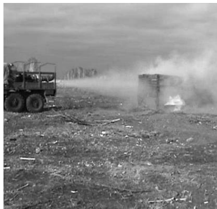
Рис. 4. Тушение очага пожара деревянного строения потоком аэрозоля 30 % раствора K_3[Fe(CN)_6]
