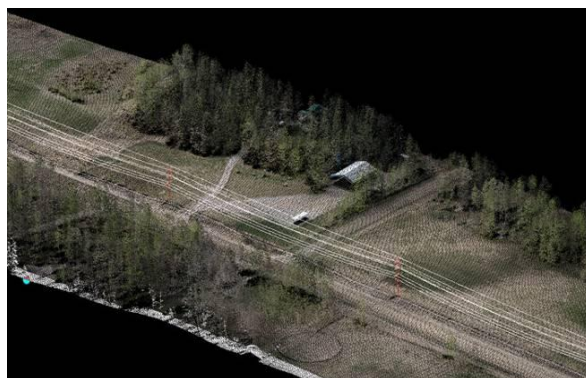
Рис. 1. Точечная модель, полученная в результате лидарной съемки
