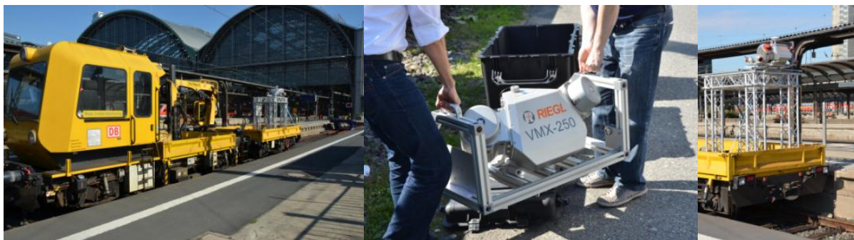
Abb. 1: Laser Scanning System RIEGL VMX ® -250 System auf einem Gleisarbeitsfahrzeug der Deutschen Bahn „GAF 100“ mit Ladekran.
