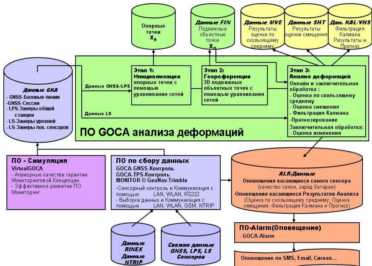
Рис. 2. Схема потоков данных и этапов анализа деформаций в ПО GOCA
