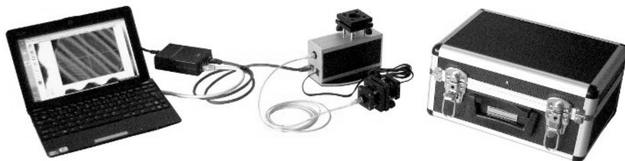
Рис. 6. Мобильный интерферометр для лабораторных измерений и производственного контроля качества оптических компонентов
