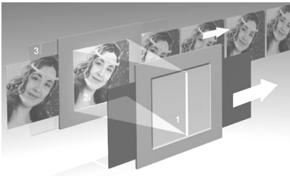
Рис. 1. Получение мультиплексной голограммы
