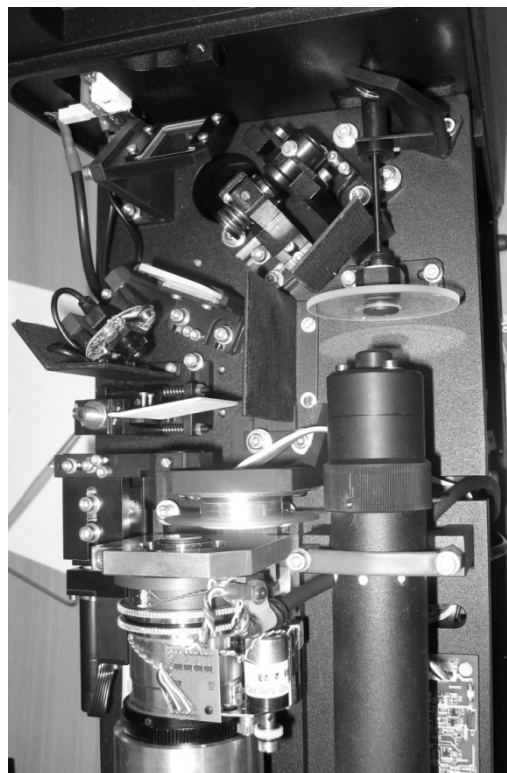
Рис. 5. Оптический блок интерферометра ФТИ-100
