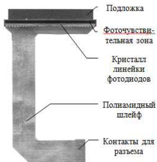
Рис. 1. Внешний вид бескорпусной линейки фотодиодов БЛПП-369
