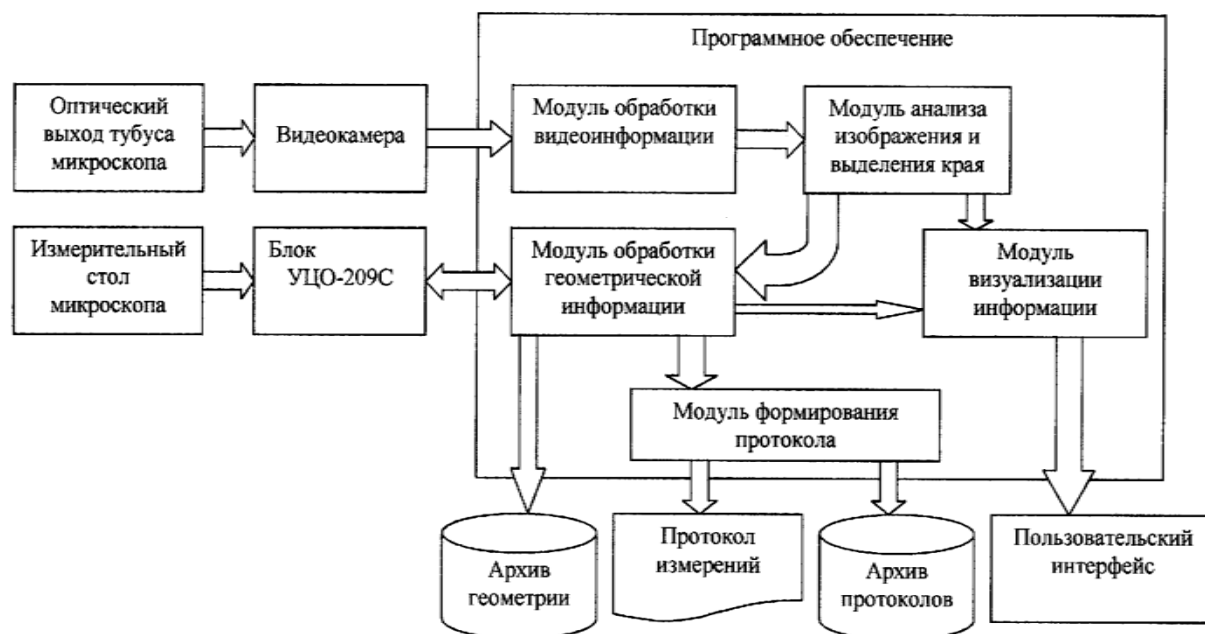
Рис. 1. Функциональная схема системы захвата изображения и автоматизированной обработки результатов измерений микроскопа ИМЦЛ
