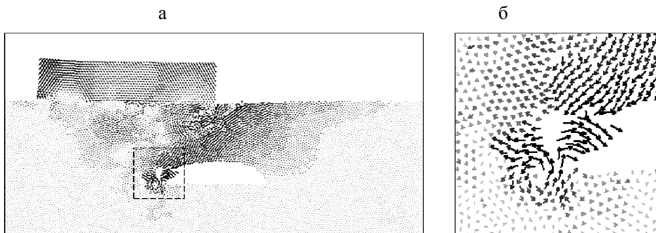
Рис. 3. Поле скоростей на одной из стадий обрушения карстовой полости: общая картина, участок интенсивного обрушения выделен штриховой линией ( a ); участок интенсивного обрушения в увеличенном масштабе ( b )
