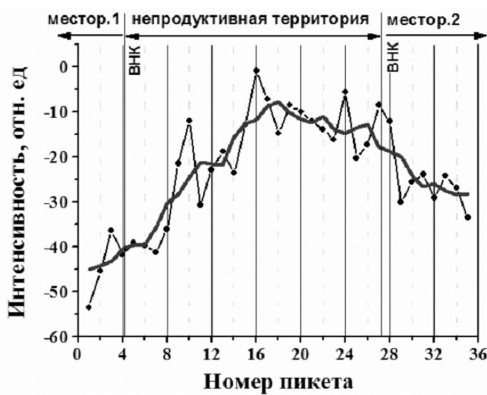
Рис. 1. Изменение интенсивности потока импульсов вдоль профиля, пересекающего два месторождения нефти
