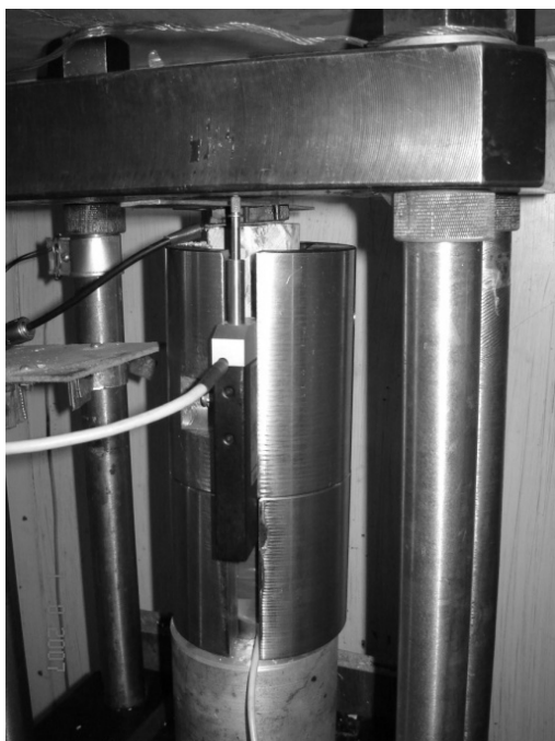
Рис. 5. Внешний вид датчика продольных перемещений в стенде при эксперименте на образце розового мелкозернистого мрамора
