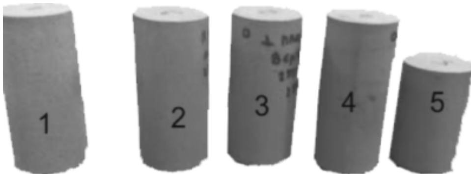
Рис. 2. Образцы для исследование на двухосное сжатие
