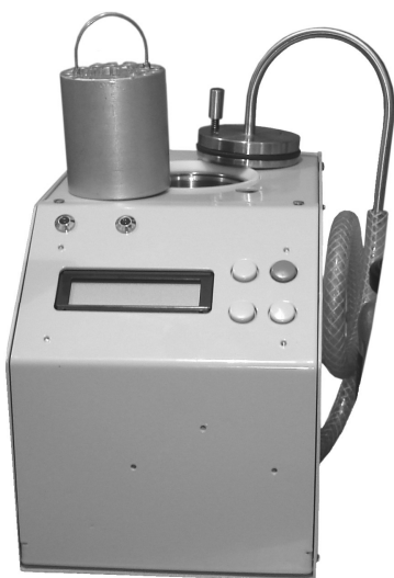
Рис. 3. Десорбер для очистки концентраторов
