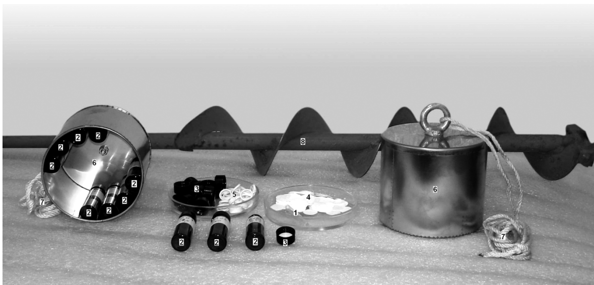
Рис. 5. Контейнер для переноски и хранения концентраторов и приспособления для пробоотбора
