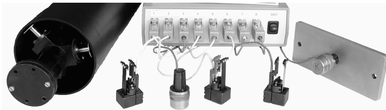
Рис. 2. Восьмиканальная тензометрическая станция с поляризационно-оптическими датчиками напряжений различных конструкций
