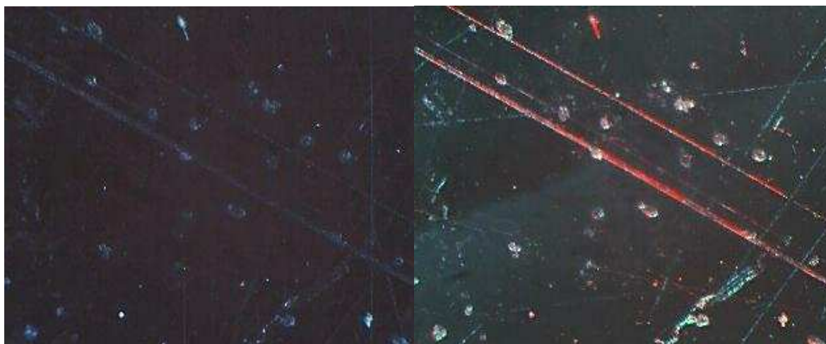
Рис. 2. Дефекты органического стекла
