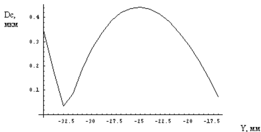
Рис 3. Размер каустики в меридиональной плоскости в зависимости от поперечной координаты y формируемого изображения
