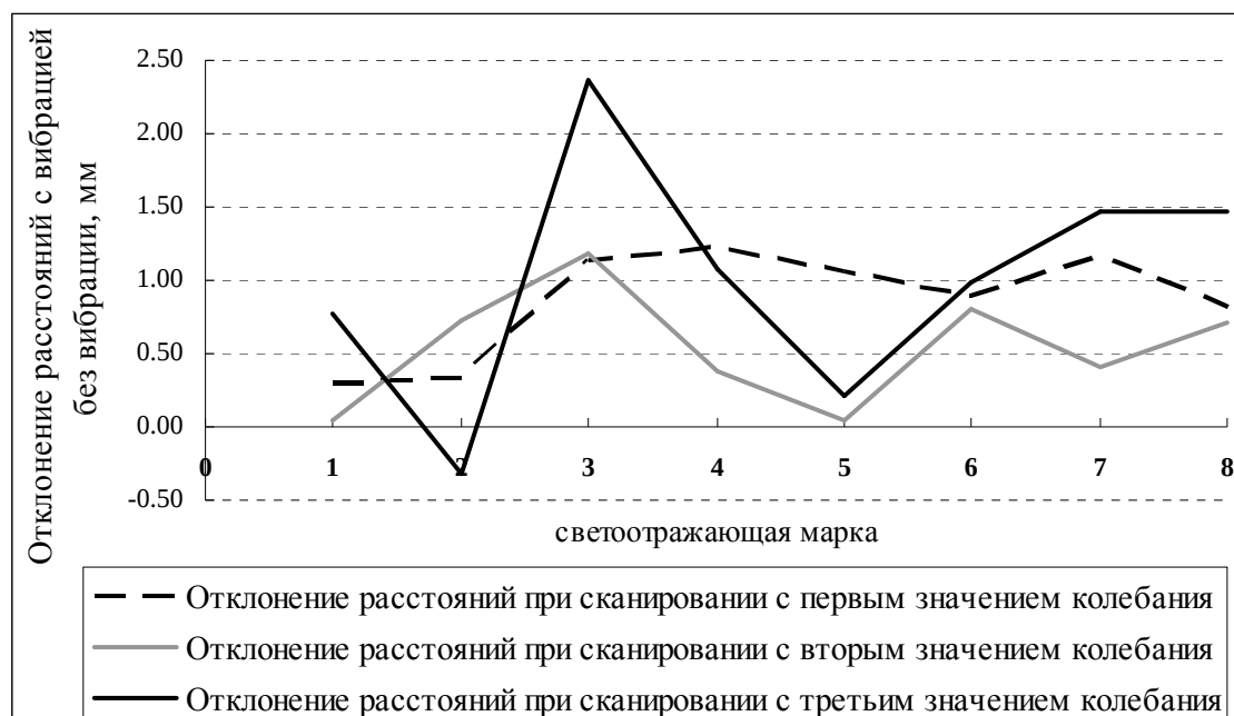
Рис. 4. Отклонение расстояний от сканера до точек на основе значений вибрации штатива при расстоянии между ножками штатива, равном 93 см
