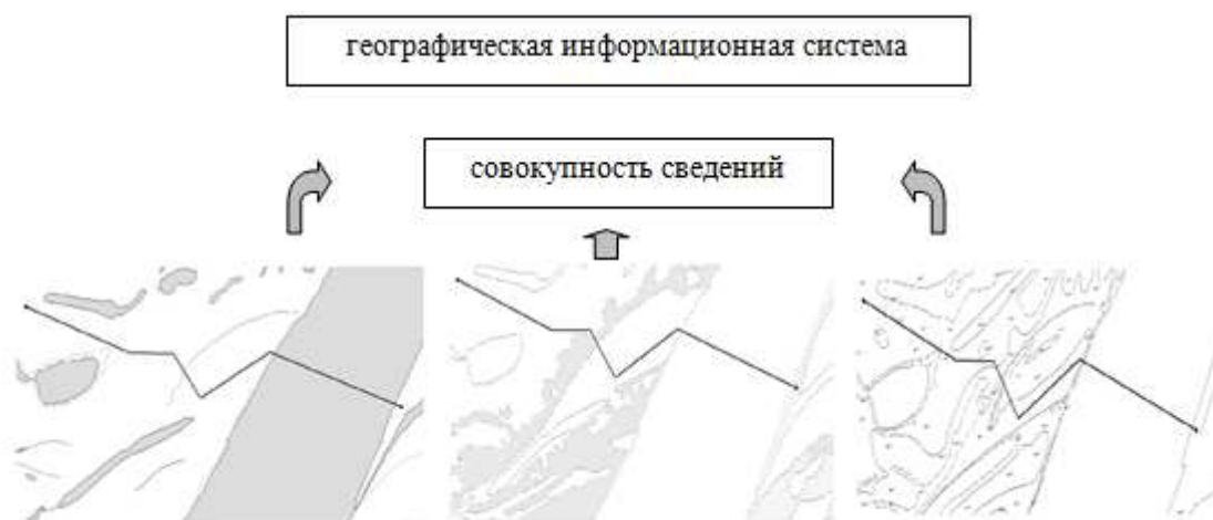
Рис. 1. Применение ГИС технологий, как способ интеграции разрозненной информации о факторах влияющих на пространственное положение проектируемого объекта
