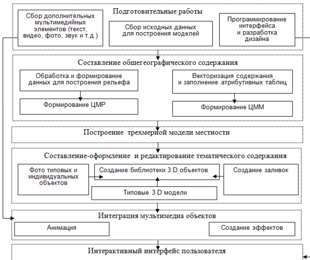
Рис. 1. Предлагаемая схема реализации трехмерной модели туристического комплекса «Пихтовый гребень»
