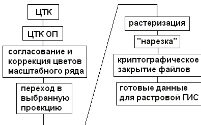
Рис. 1. Технологическая схема подготовки картографической основы для растровой ГИС
