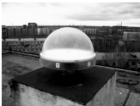
а) антенна б) приемник Trimble Net R5 с сервером
