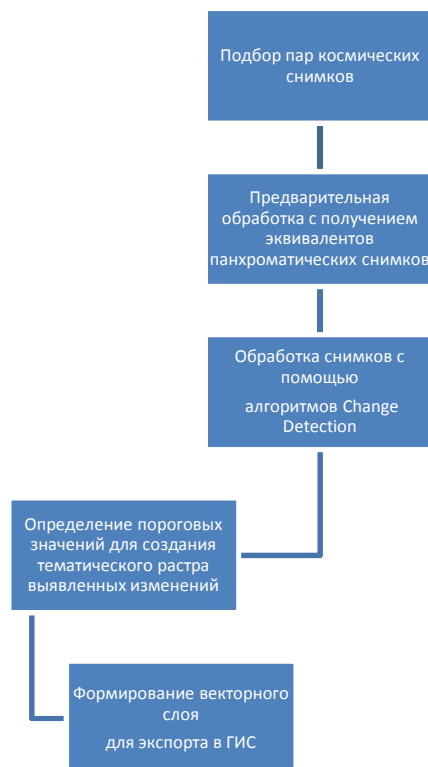
Рис. 1. Технологическая схема выявления изменений на местности по разновременным космическим снимкам
