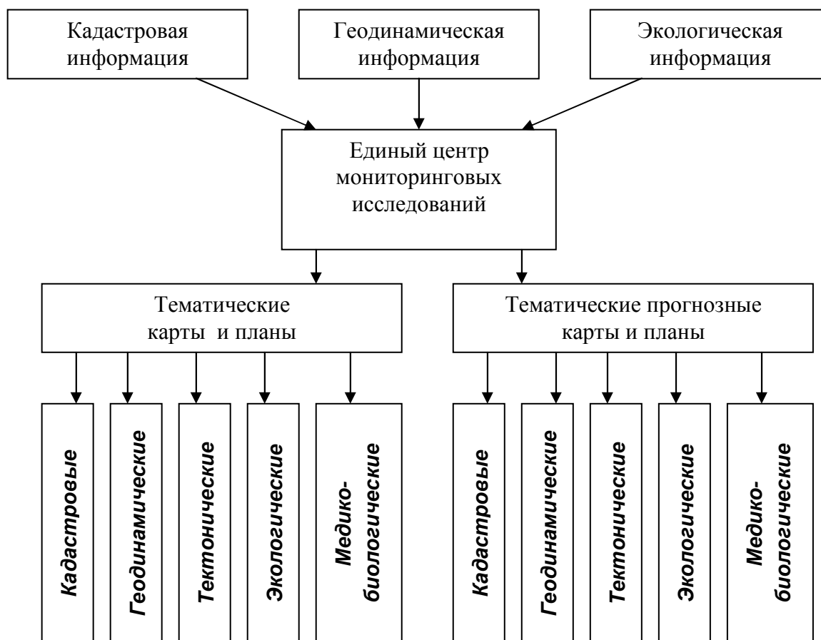
Рис. 2. Блок-схема единого центра мониторинговых исследований
