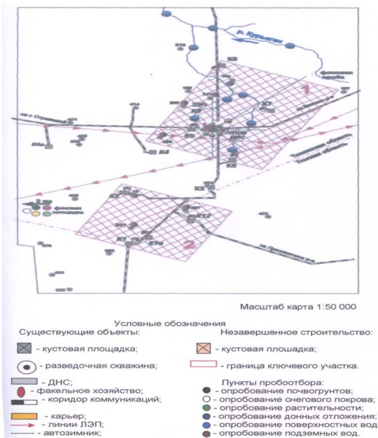
Рис. 1. Схема геоэкологического мониторинга Северного нефтегазового месторождения
