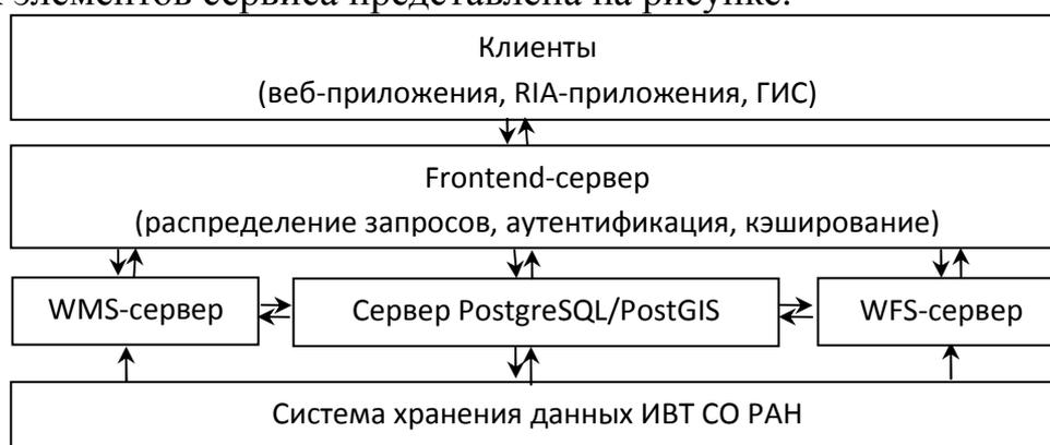
Структурная схема картографического сервиса
