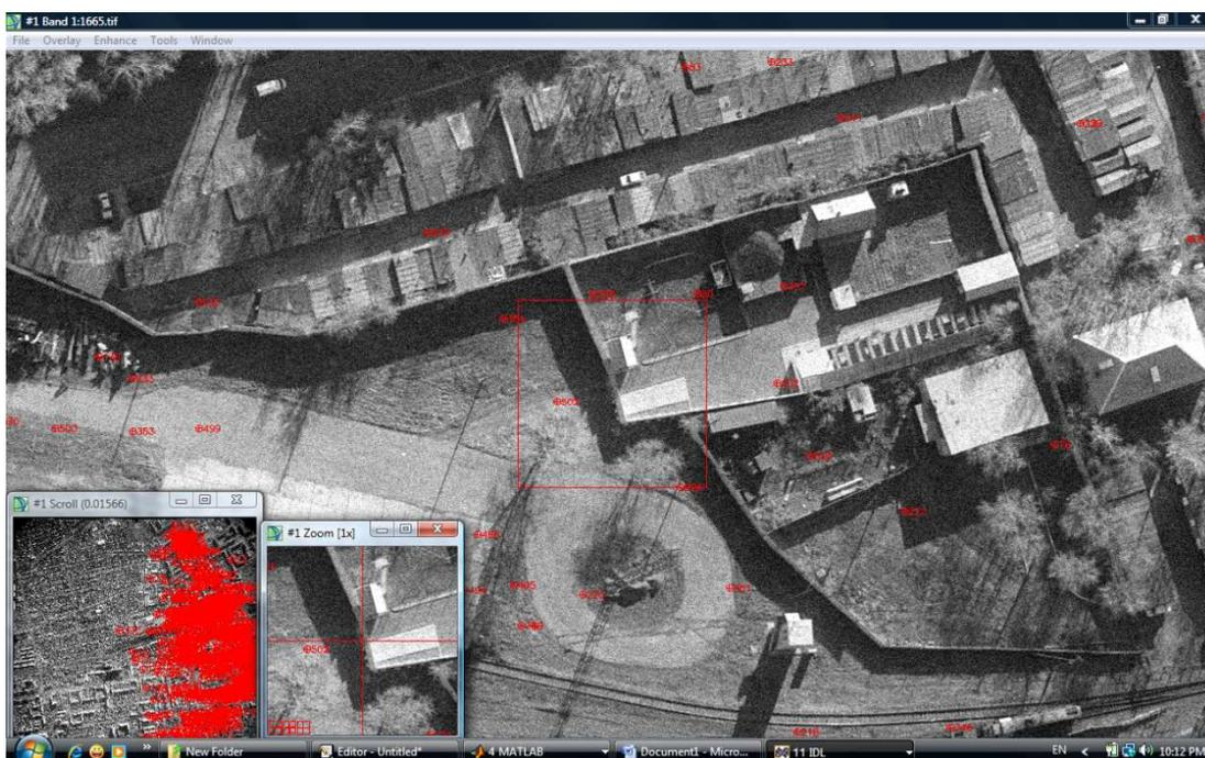
Рис. 1. Результат выделения точек на аэроснимке
