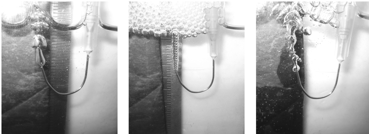
Рис. 1. Режимы течения воздуха, не соответствующие режиму одиночных пузырей
