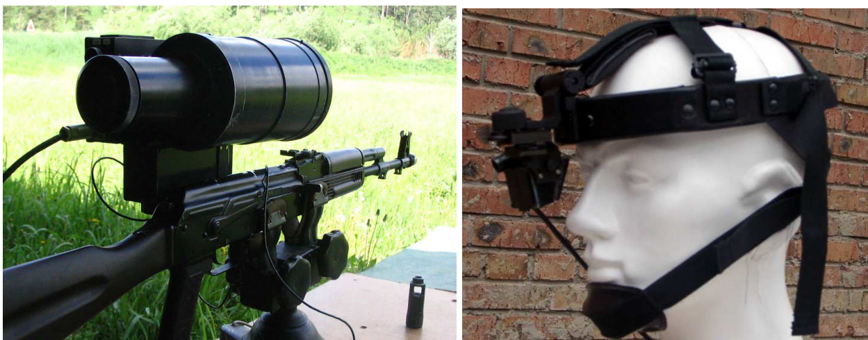
Рис. 1. Внешний вид двухспектральной обзорно-прицельной системы с разнесенными модулями прицеливания (слева) и визирования (справа)
