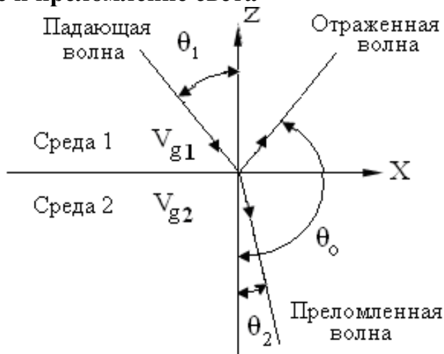
Рис. 3. Отражения и преломление волн на границе двух сред
