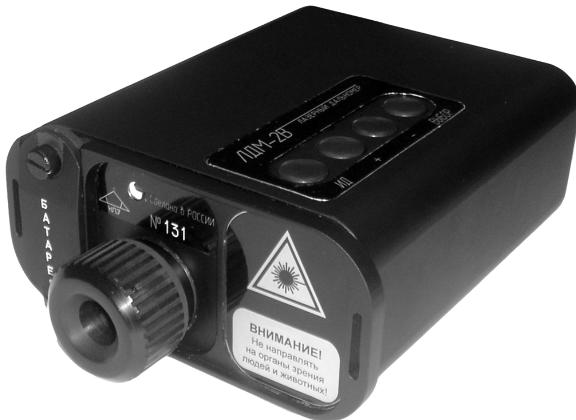
Рис. Внешний вид дальномера ЛДМ-2В
