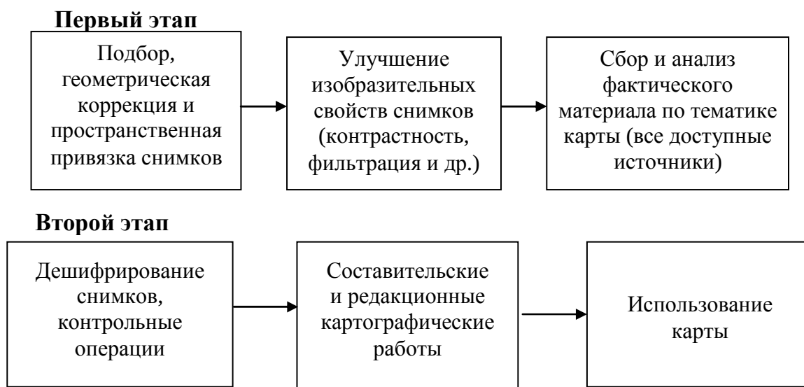
Рис. 1. Обобщенная схема технологии геоинформационного картографирования районных муниципальных образований с использованием космических снимков
