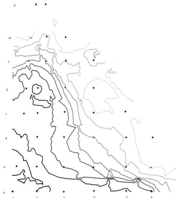
Рис. 1. Цифровая модель интерполяции осадок фундаментов инженерного сооружения
