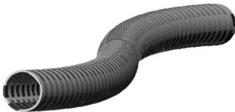
Рис. 2. Форма тоннеля, собранного усечёнными железобетонными тубингами
