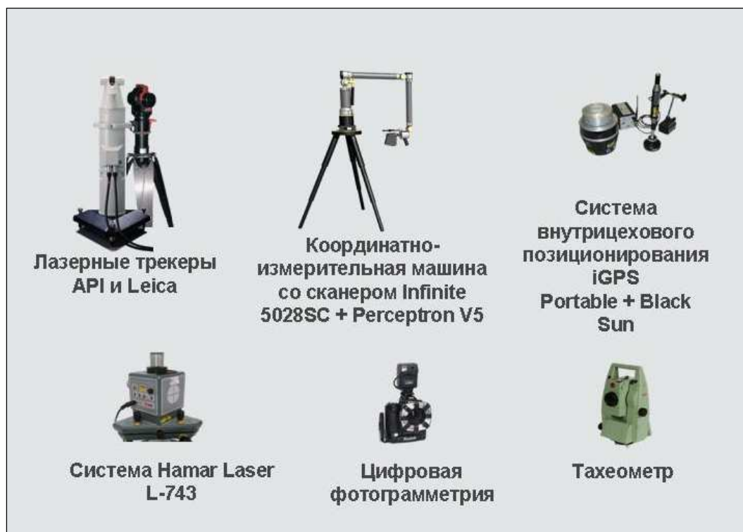
Рис. 8. Оборудование, применяемое специалистами VMT для проведения промышленных измерений
