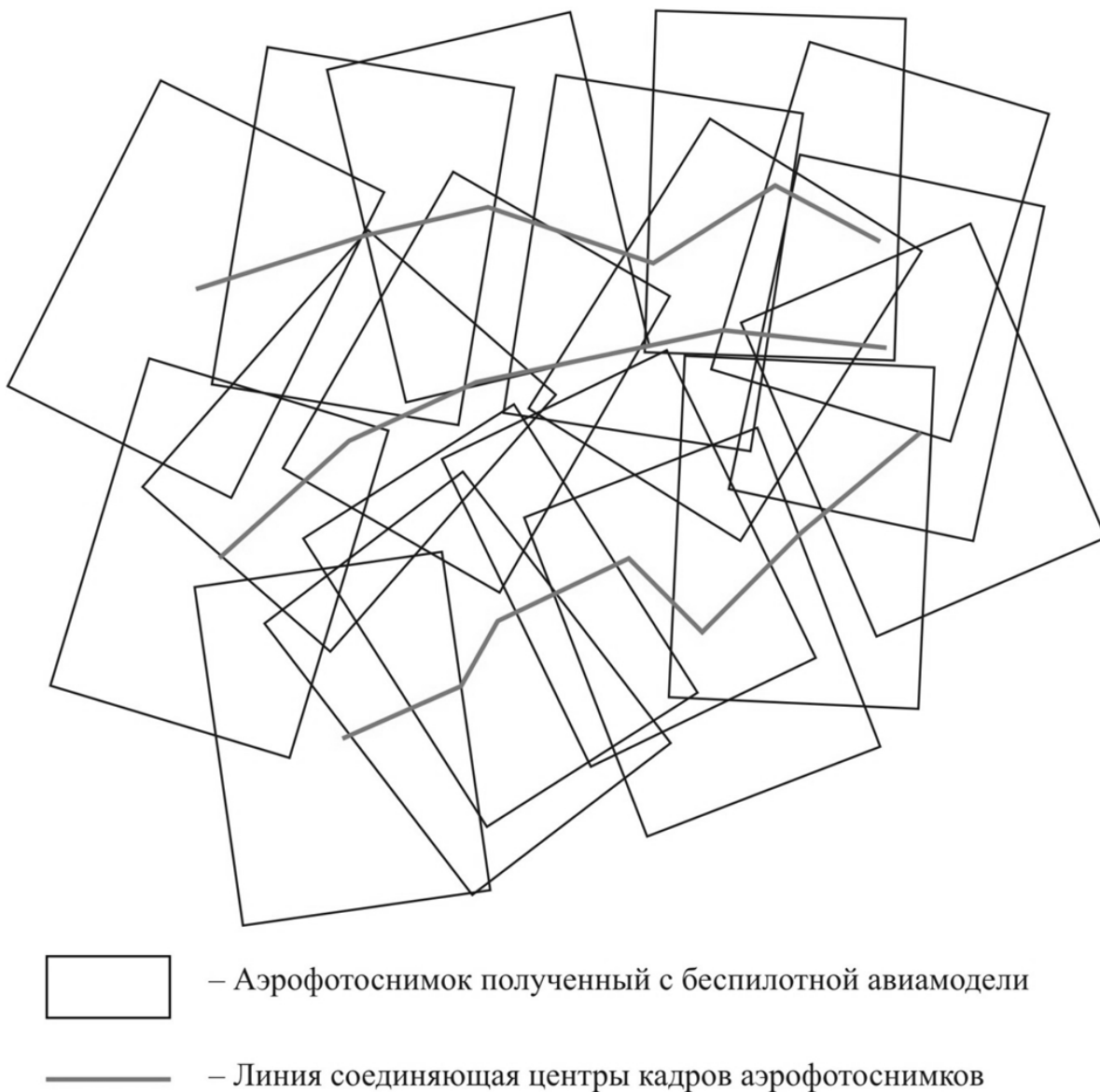
Рис. 1. Схема блока из аэрофотоснимков, полученных с беспилотной авиамодели
