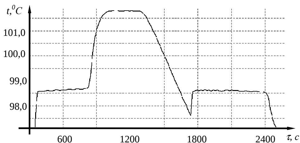
Рис. 4. Кривые плавления и затвердевания Na (1г), позволяющие воспроизводить температуры с погрешностью 0,1^{\circ}\text{C}
