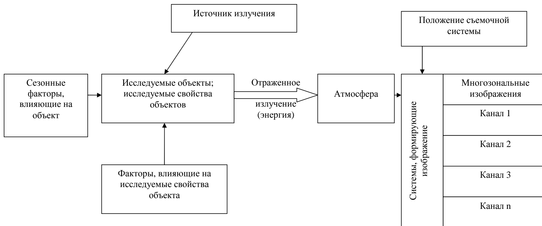
Рис. 1. Схема исследования объекта с использованием систем, формирующих многозональные изображения
