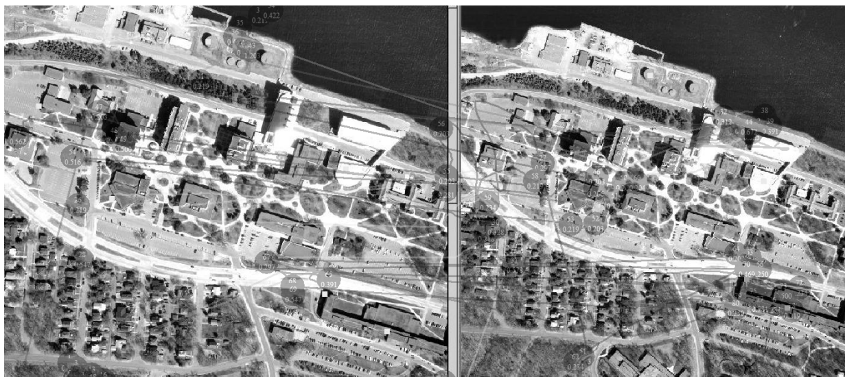
Рис. 2. Визуально комфортный набор изображений: изоморфные данные (стереопара аэроснимков одного маршрута). Набор RIB-1
