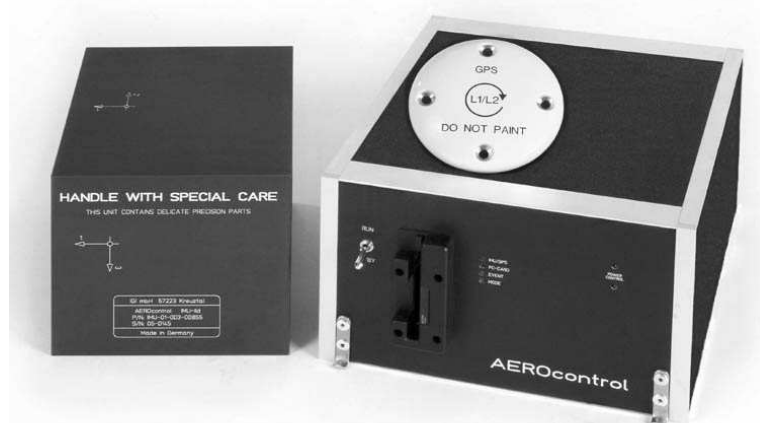
Рис. 3. Система прямого геопозиционирования AEROcontrol компании IGI mbH
