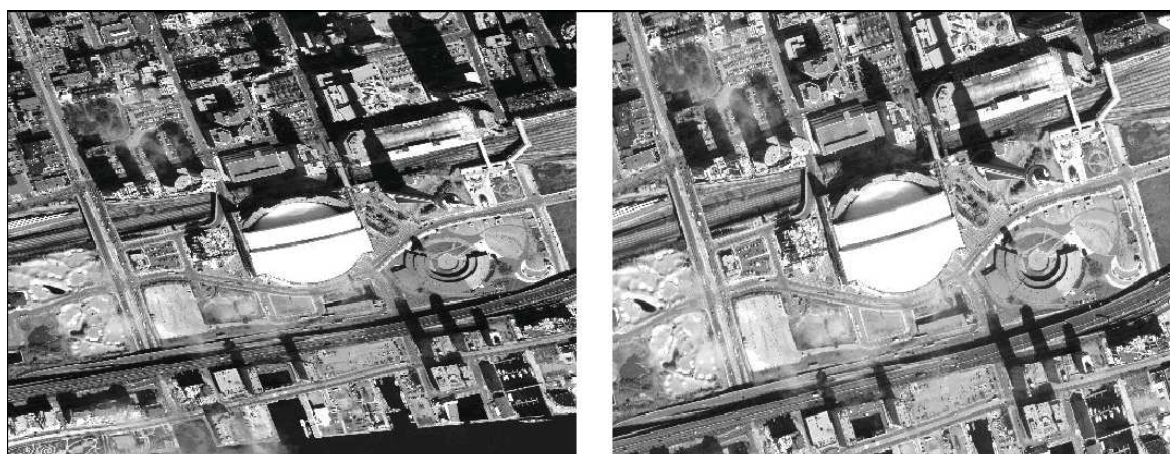
Рис. 1. Изображение Quickbird до и после ортотрансформирования
