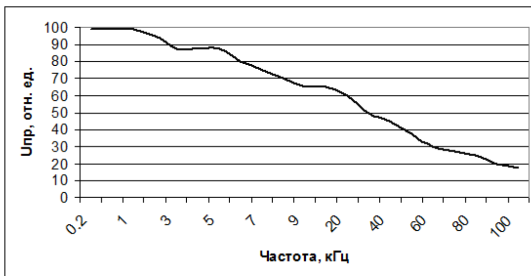
Рис. 2. Частотные характеристики лампы ДРЛ-125
