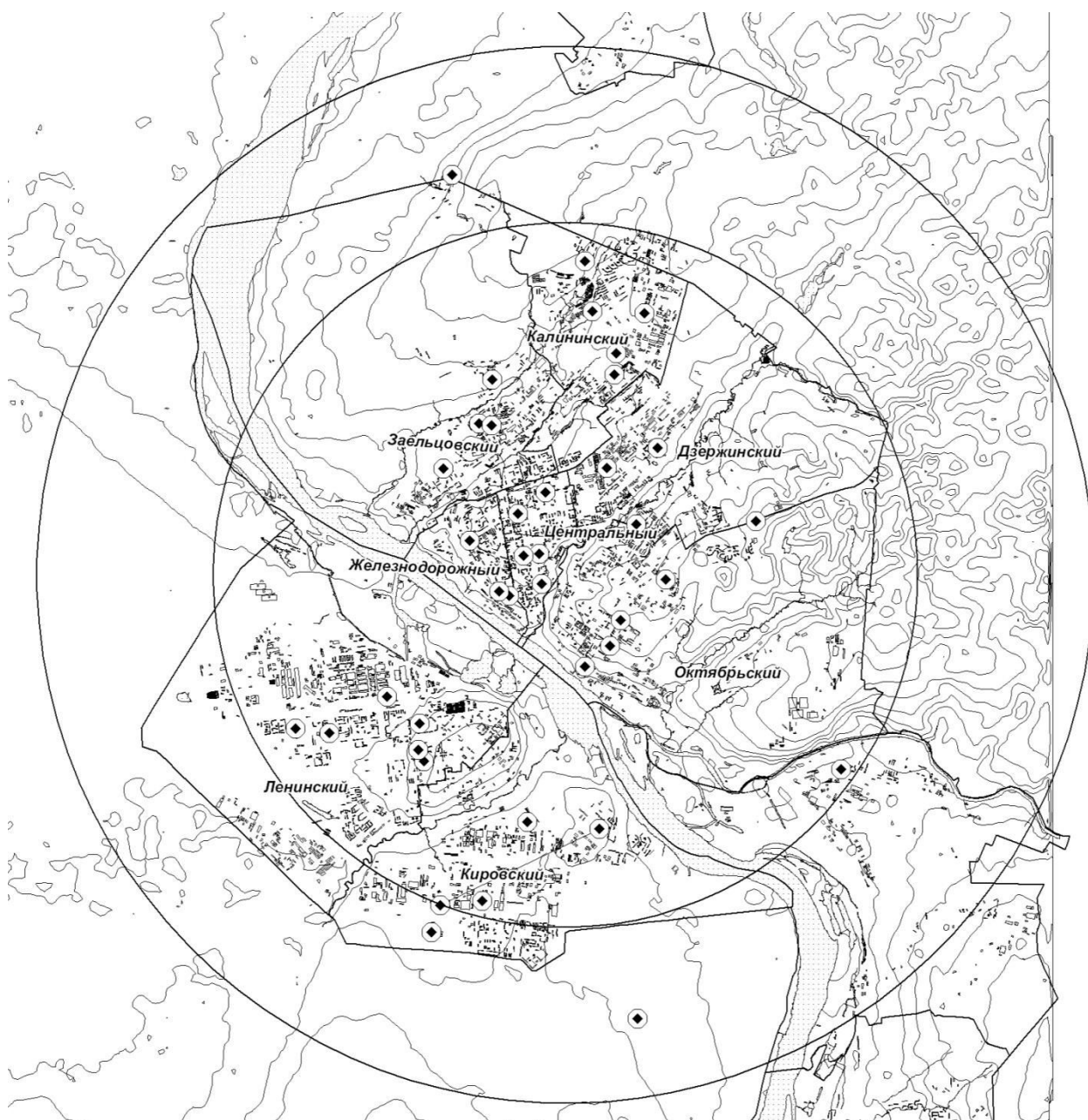
Рис. 2. Схема определения зон видимости в зависимости от высоты рельефа и длины радиолуча
