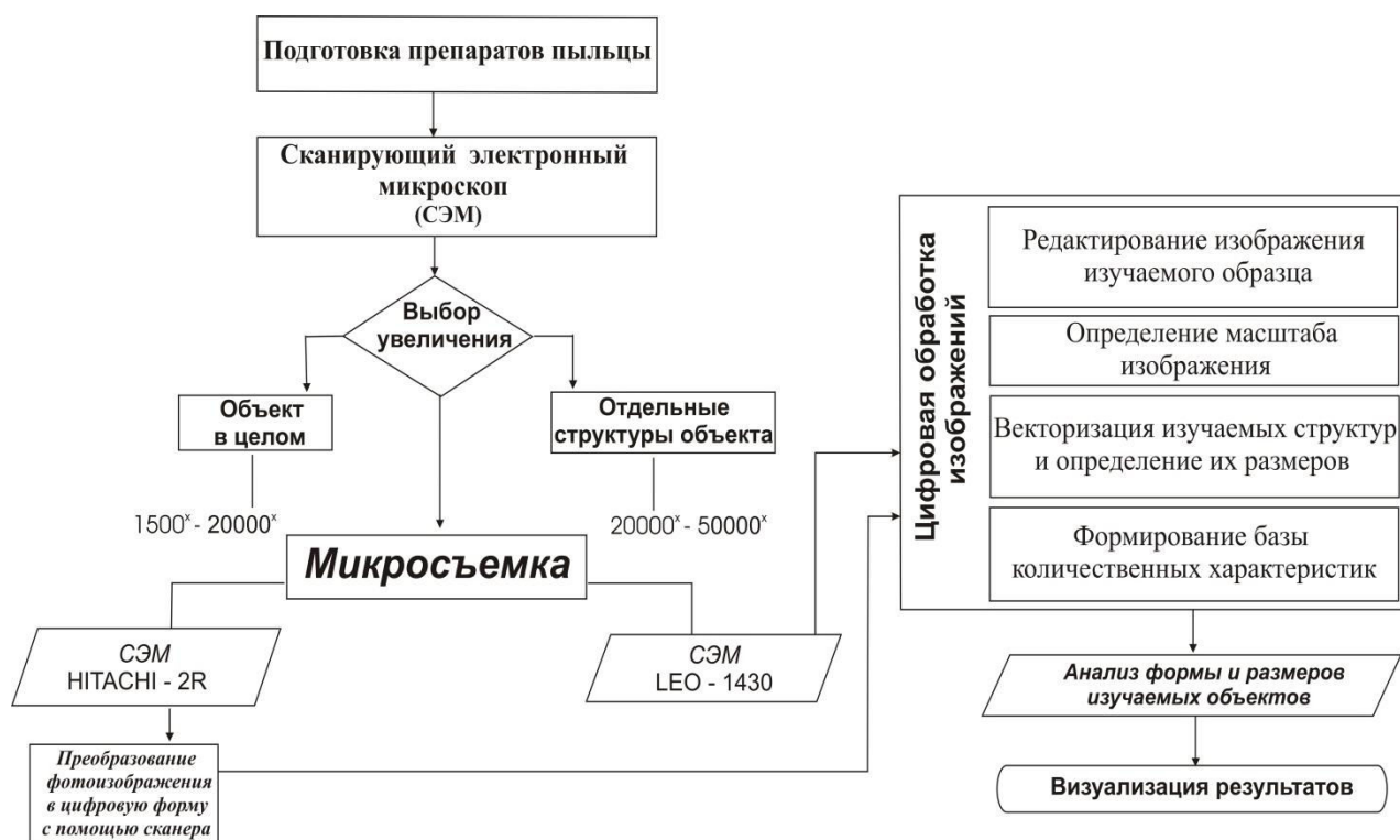
Рис. 1. Основные процессы получения и обработки микроизображений
