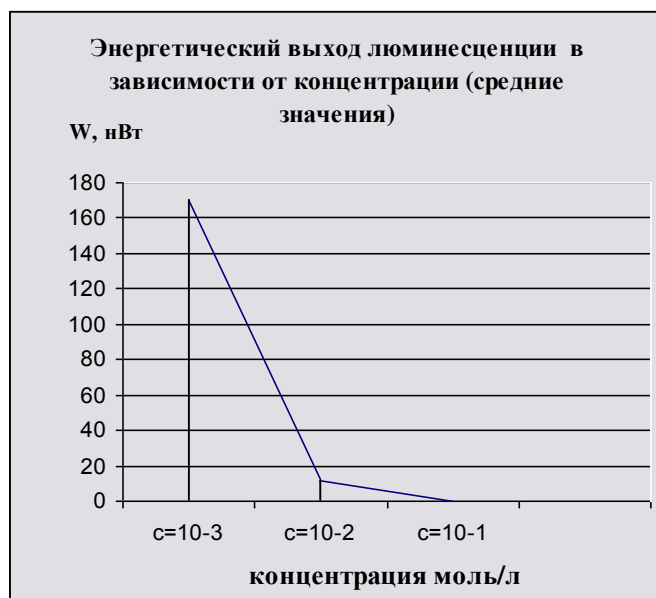
Рис. 5. Зависимость энергетического выхода для люминофора пара – Терфенил
