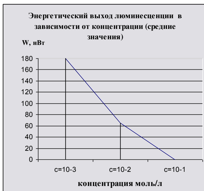
Рис. 4. Зависимость энергетического выхода для люминофора РОРОР
