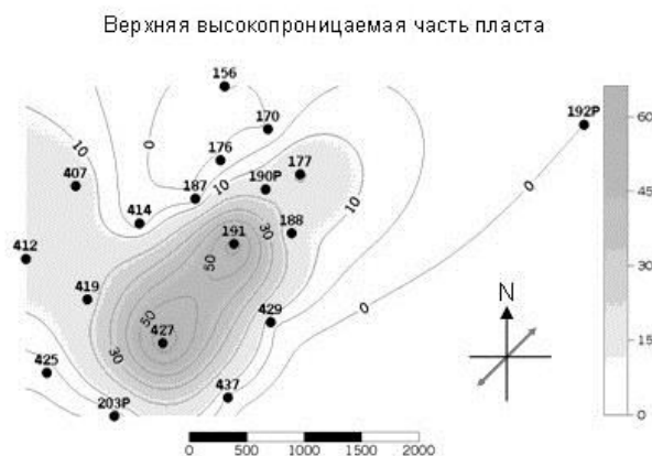
Рис.2. Распределение проницаемости коллектора по данным керна и ГИС (толщина пласта 2 м, вертикальная шкала – диапазон изменений проницаемости, единицы измерения – миллиарды)
