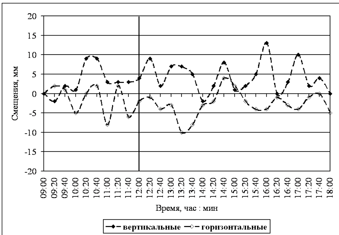
Рис. 6. Изменение смещений земной поверхности на границе зоны тектонической нарушенности до и после массового взрыва блока 30 в этаже (–280) – (–210) м 2.10.05 г.
