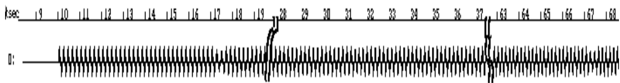
Рис. 4. Динамика формы волны восстановленного свип-сигнала
