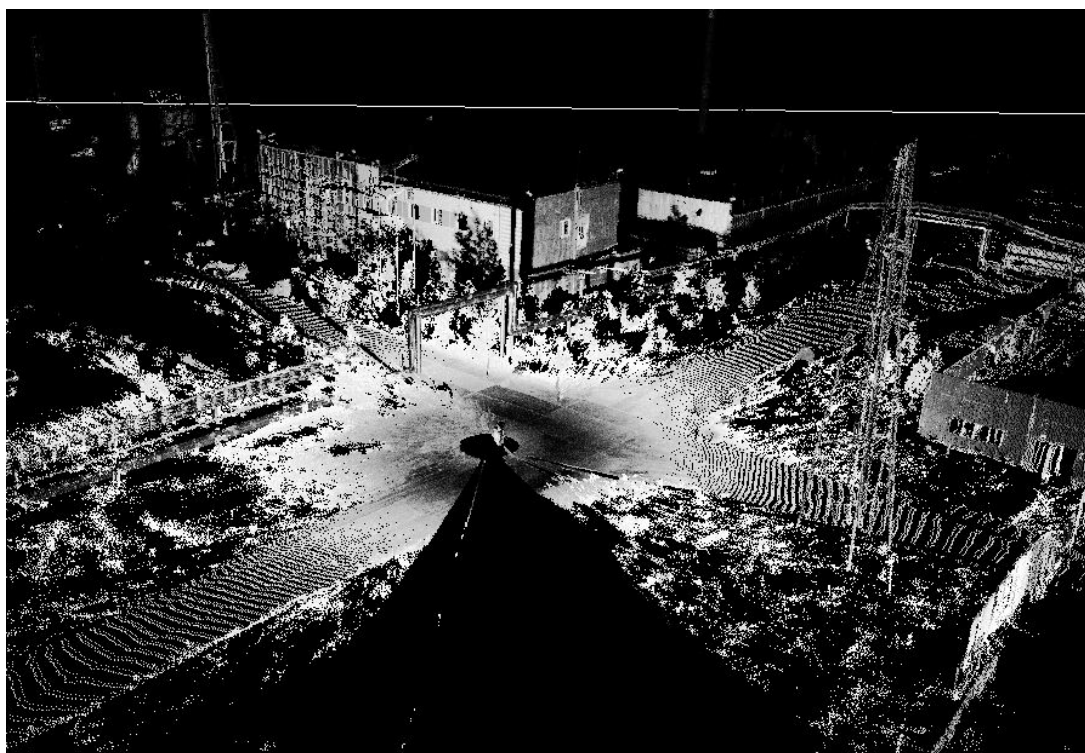
Рис. 4. Типовое лазерно-локационное изображение в дальномерной форме, полученное с помощью наземного лазерного сканера
