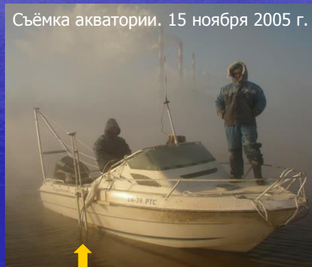
Забортное крепление излучателя эхолота
