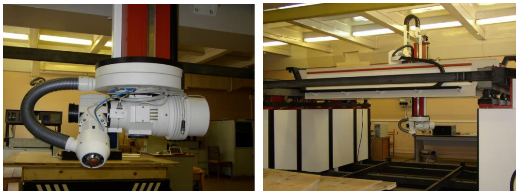
Рис. 14. Внешний вид комплекса LSP-2000 (справа) и крупным планом - головка лазерного исполнительного элемента (слева)
