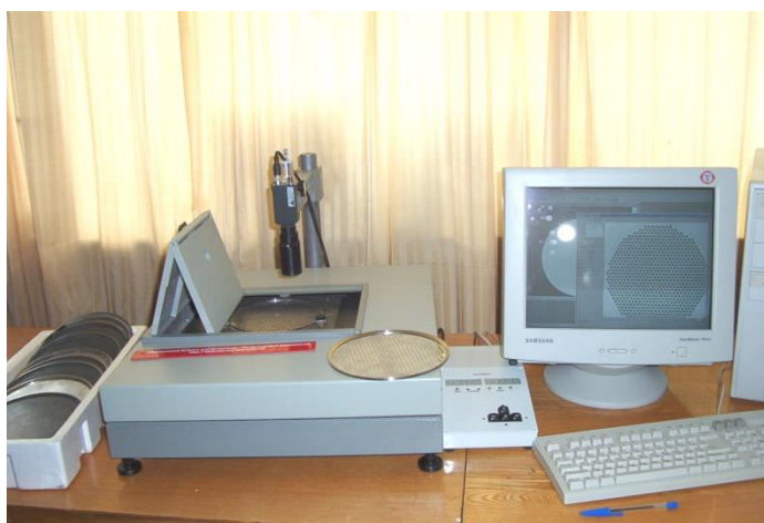
Рис. 10. Внешний вид системы СИТО (слева) и пример результата измерения образца сита на экране монитора (справа), где для наглядности диапазоны измеренных диаметров отверстий отображены разными цветами
