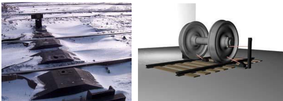
Рис. 8. Внешний вид системы КОМПЛЕКС (слева) и принцип автосканирования геометрических параметров колесной пары системой (справа)
