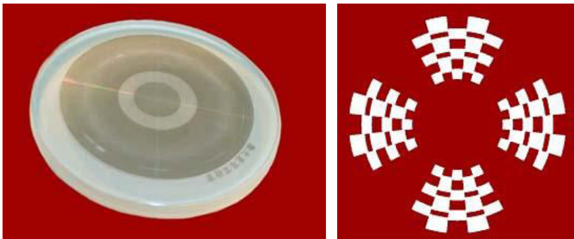
Рис. 12. Примеры записей, сделанных с помощью CLWS-300/С-М: слева - дифракционная структура на элементе сферической поверхности, диаметр подложки - 50 мм, радиус кривизны - 240 мм, справа - тестовое изображение для исследования процесса записи по хрому (диаметр 350 мкм, минимальные размеры элементов 10 мкм × 10 мкм)
