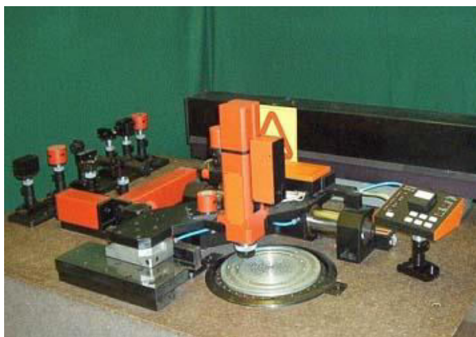
Рис. 11. Внешний вид лазерного генератора изображений CLWS-300/C-M в табл. 3.
