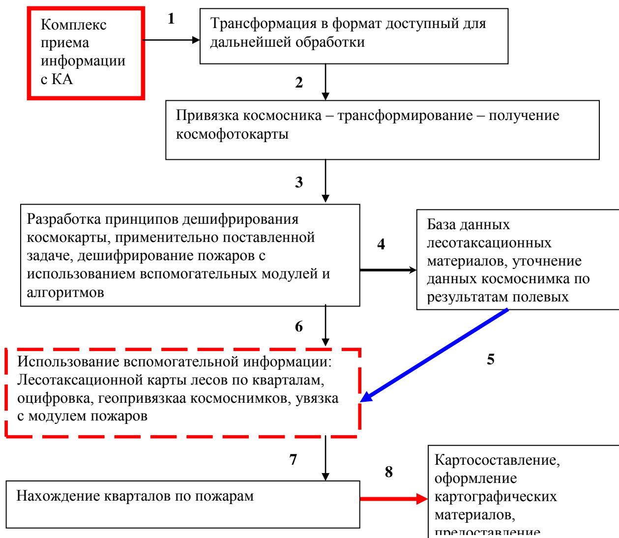
Рис. 2. Схема функционирования информационно-программного комплекса обнаружения лесных пожаров
