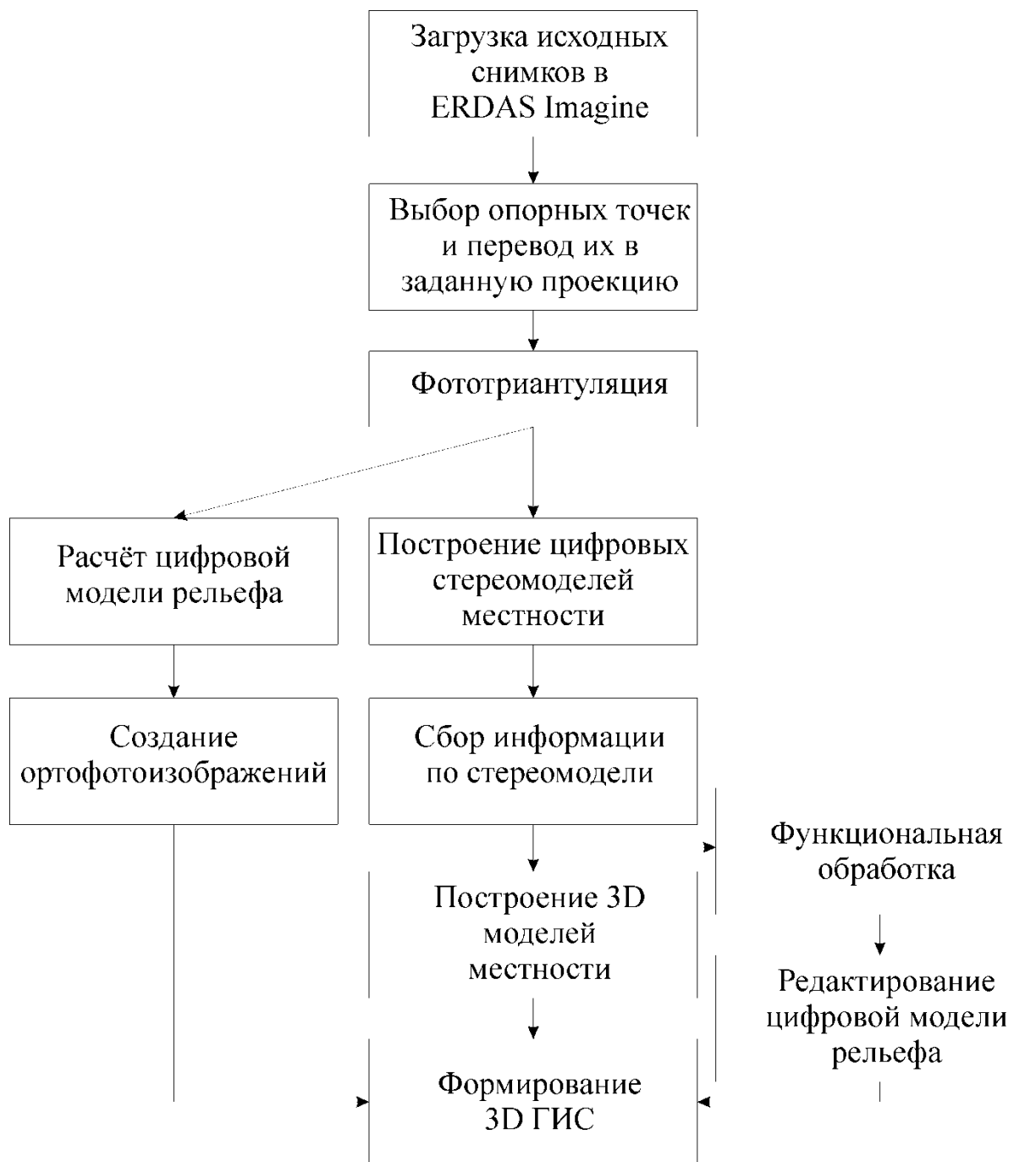
Рис. 2. Технологическая схема обработки аэрофотоснимков
