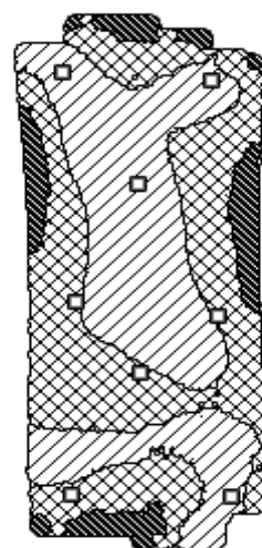
Рис. 1. Пример блока триангуляции Рис. 2. Распределение ошибок в блоке рисунка видно, что в области между опорными точками и вблизи них величина ошибки меньше, а ближе к краям блока ошибка возрастает.
