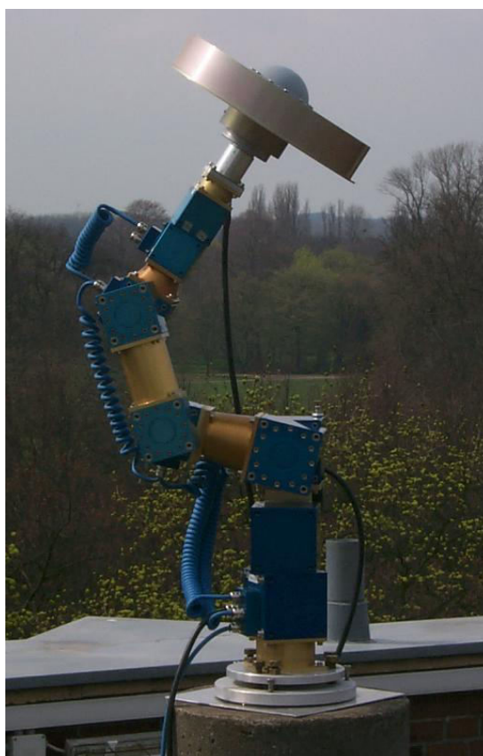
Рис. 1. DM_T антенна установленная на роботе
