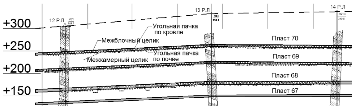
Рис. 2. Рассматриваемая типовая горнотехническая ситуация при отработке свиты пластов комплексом КГРП
